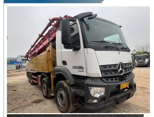
White a MERT 混凝土泵车 Truck Mounted Concrete Pump 世界制造厂 识别代号 LFC 车辆识别代号 W1FNXXACXL0476932 产品型号 SYM5449THBE 产品品牌 最大理论输送量 180 m³/h 最大布料高度 56 m 最大理论输出压力 12 MPa 最大布料半径 51 m 发动机型号 总质量 44000 kg OM470LA.5-54 发动机最大 净功率/转速 315 kW/ 1600 r/min 整车整备质量 43870 kg Engne Max/NARPower/Speed Kerb Mass 发动机排量 Engen Dantagement 10677 mL 发动机额定功率 320 kW 外形尺寸(长×宽×高) 13860mmX2550mmX4000mm 生产日期 2021-04 出厂编号 BC5449CA7778 中国制造 / Made in Ch 10
